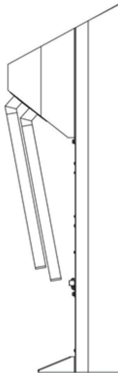
Рисунок 17 – Турникет со сложенными планками (центральная стойка турникета)
